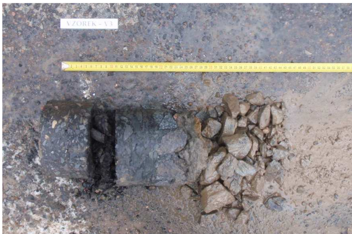
Obr. 5 - Jádro vývrtu Vzorek – V3 (in situ).
