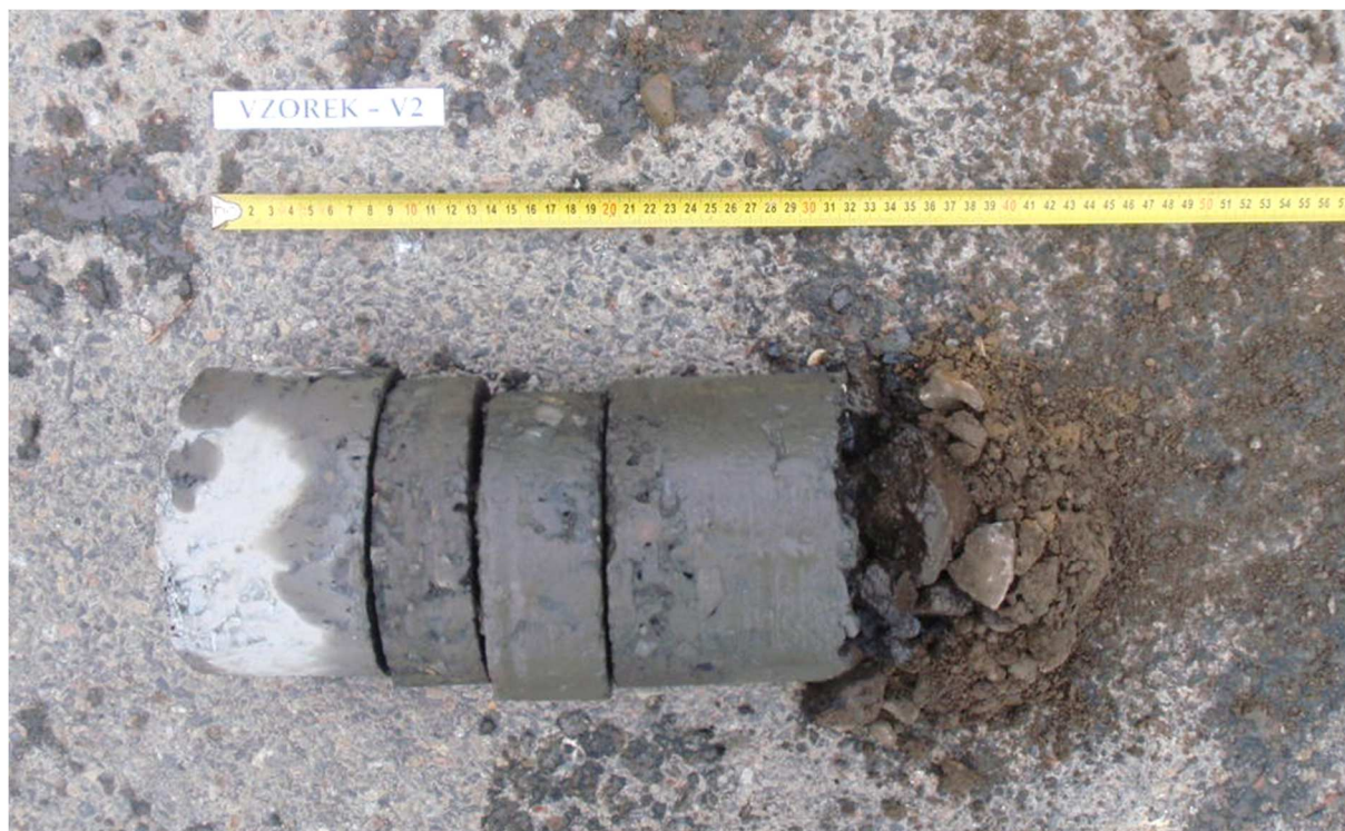
Obr. 3 - Jádro vývrtu Vzorek – V2 (in situ).
